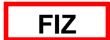
Bild: Kennzeichnung BMZ bzw. FIZ nach DIN 4066
