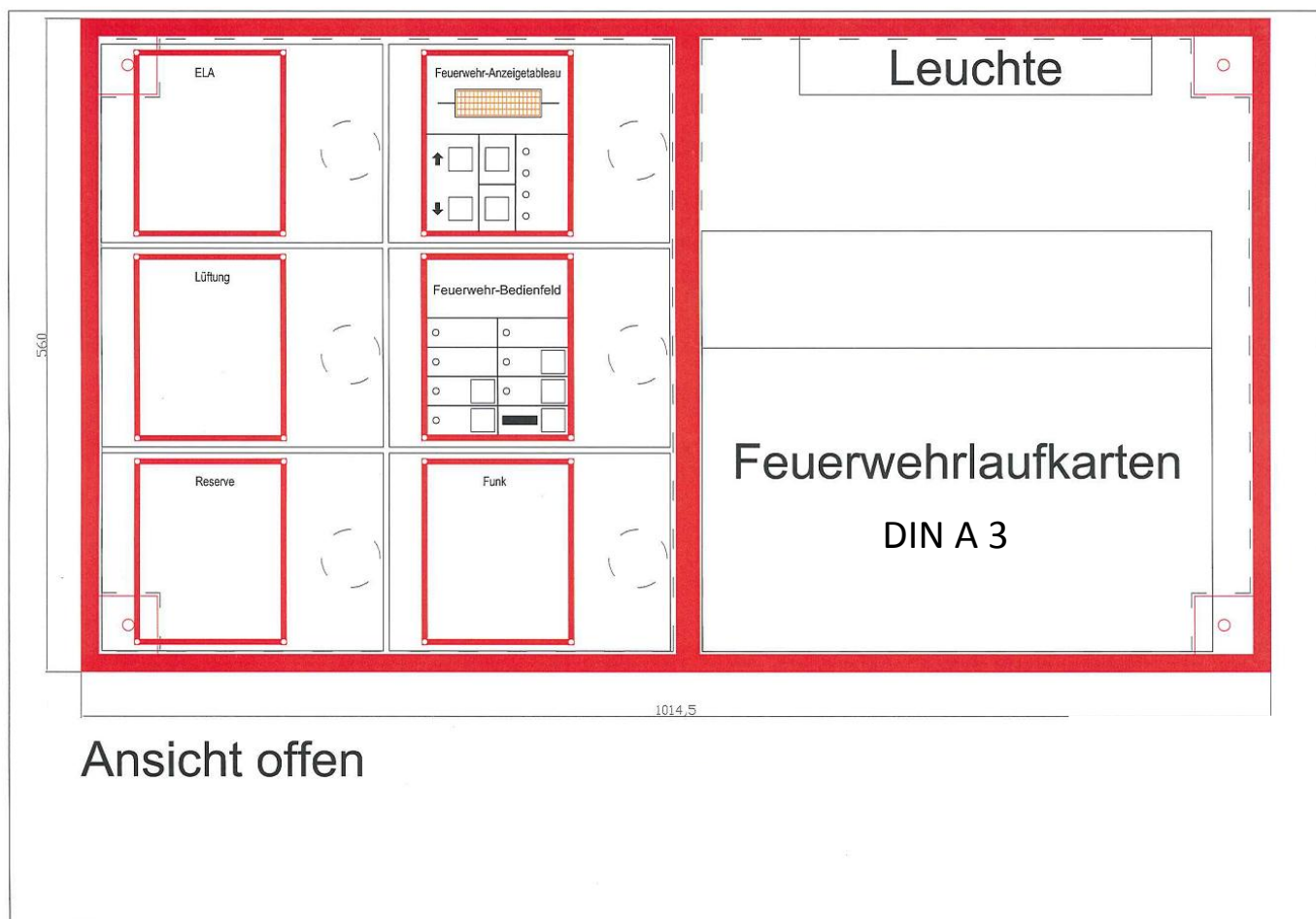
Bild 9.) Feuerwehr-Information und Bediensystem (FIBS) Maße: Höhe:560 mm ; Breite: 1014,5 mm; Tiefe: 150 mm
