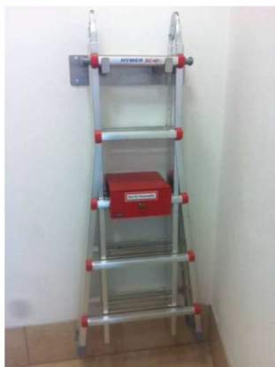
Beispiel einer möglichen Leitersicherung
