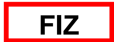
Bild: Kennzeichnung BMZ bzw. FIZ nach DIN 4066
