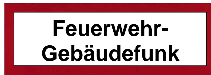
Bild 27.) Kennzeichnung Zugang Gebäudefunkanlage Maße 297 mm x 105 mm
